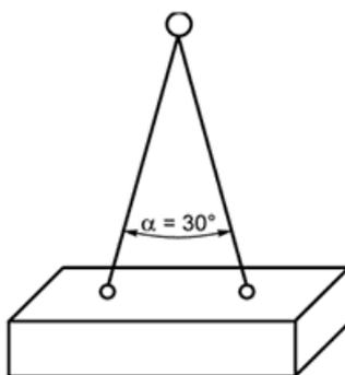
б) Угол между стропами  $30^\circ$ , масса груза 7 т
